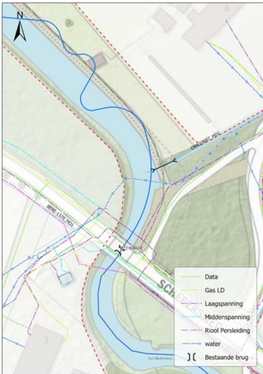
Figuur 35 Krusing van nieuw tracé Groote Beerze met kabels en leidingen ter hoogte van de Schepersweg
