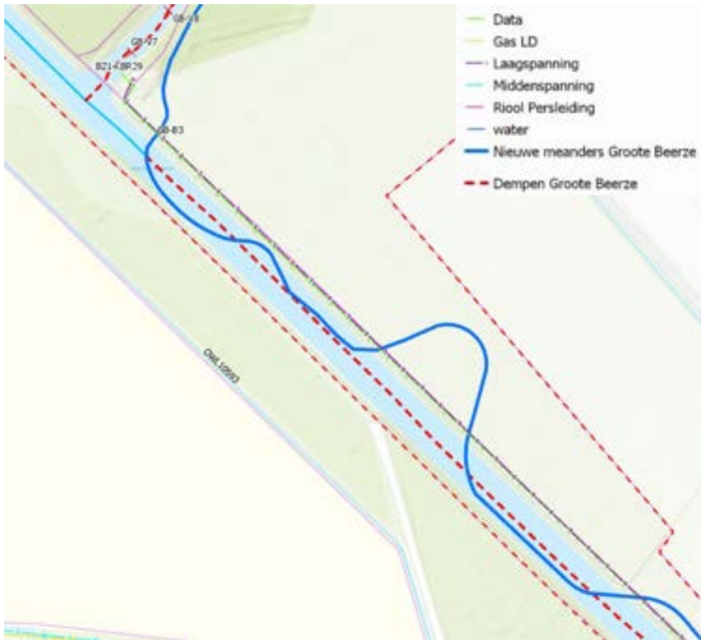
Figuur 36 Kabels en leidingen langs huidige ligging Grootte Beerze en kruisen de nieuwe meanders.
